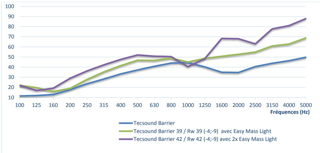
Association Easy Mass (10 kg/m<sup>2</sup>) avec Tecsound Barrier 33/45 et Tecsound Barrier 33/60
